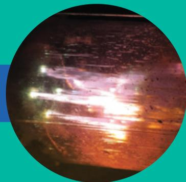
Воспламенение угля происходит за счёт высокочастотного разряда, сформированного в электродном блоке горелочного устройства.
